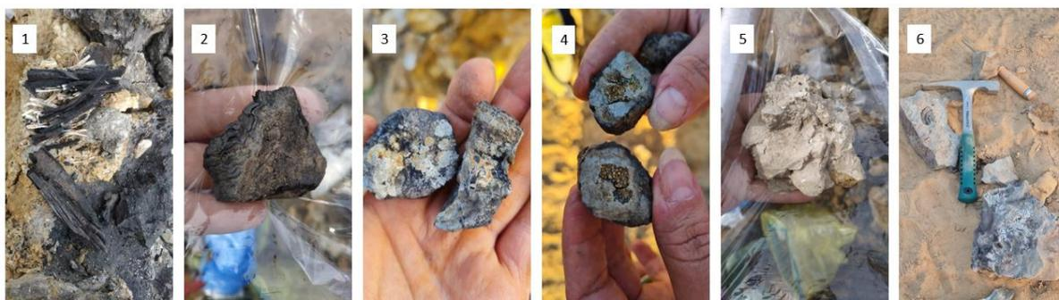
Рисунок 5. Образцы из юрских отложений, подвергшихся техногенному (бульдозеры) воздействию: 1-2 – углефицированная древесина; 2-3 – пиритизация; 4 – глина с галькой; 5 – кремний
