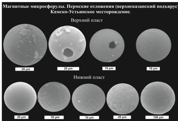
Рисунок 3.1. Изображение магнитных микросфер, полученных электронным микроскопом (Дисе., Глухов М.С. 2022)
