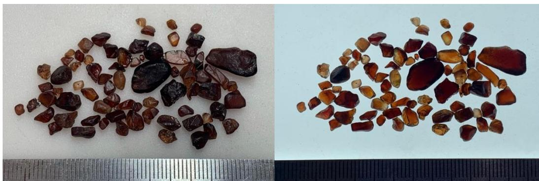
Рисунок 1. Цирконы месторождения Незаметнинское Приморского края при внешнем (слева) и в проходящем (справа) освещении
