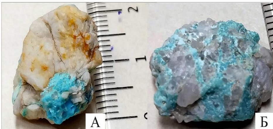
Рисунок 3. Сочетание бирюзы с различными генерациями кварца: А – кварц 2-й генерации; Б – 3-ей генерации
